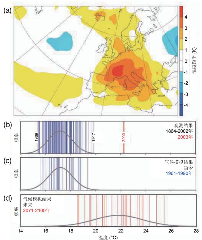
图TS - 13. 2003年夏季热浪的特征: (a) 相对于1961-1990年的6-8月温度距平; (b—d) 瑞士6-8月的温度; (b) 1864-2003年的观测结果; (c) 应用区域气候模式对1961-1990年期间进行模拟的结果; (d) 在SRES A2情景下对2071-2100年模拟的结果。图 (b-d) 中的竖线条表示在所考虑的时间周期内每年夏季的平均地面温度; 黑色表示拟合的高斯分布。[F 12.4]
