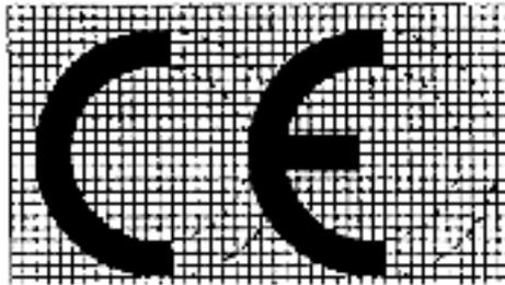
Caso a marcação CE seja reduzida ou aumentada, em função da dimensão do equipamento, devem respeitar-se as proporções apresentadas no desenho acima. As várias componentes devem ter substancialmente a mesma dimensão vertical, que não pode ser inferior a 5 mm.
